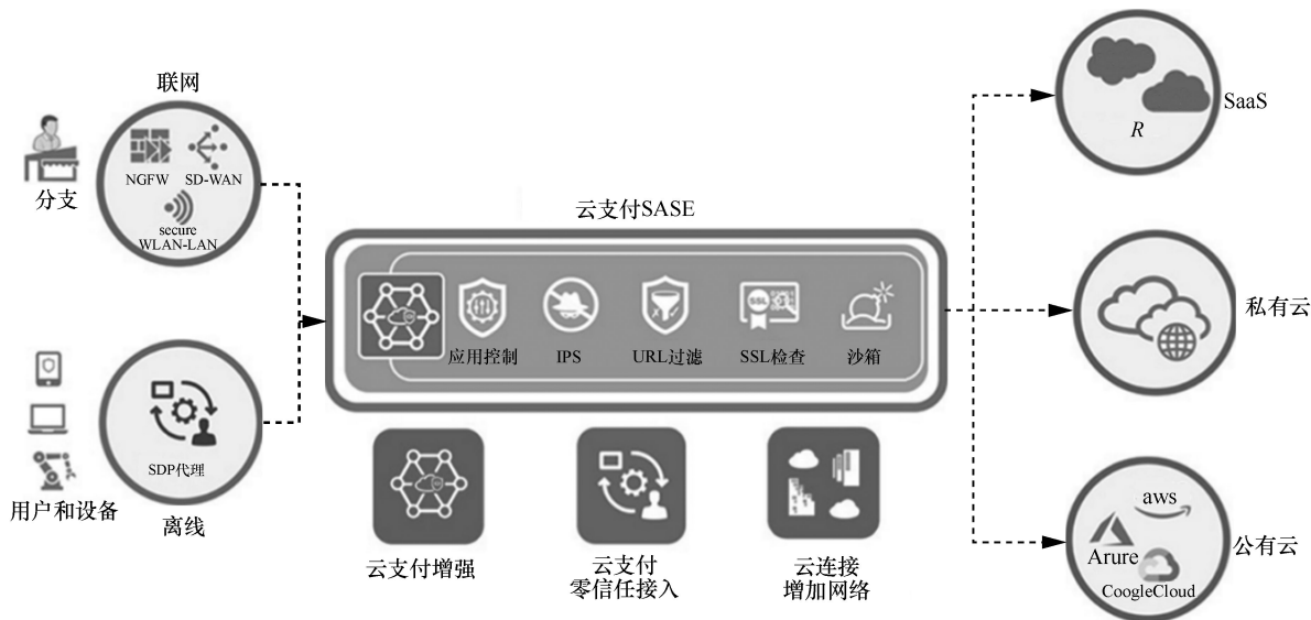
图 2 SASE 分布式安全服务原理
